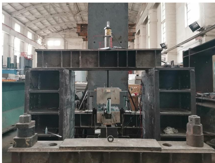
图 32 拉结件双拉试验装置
