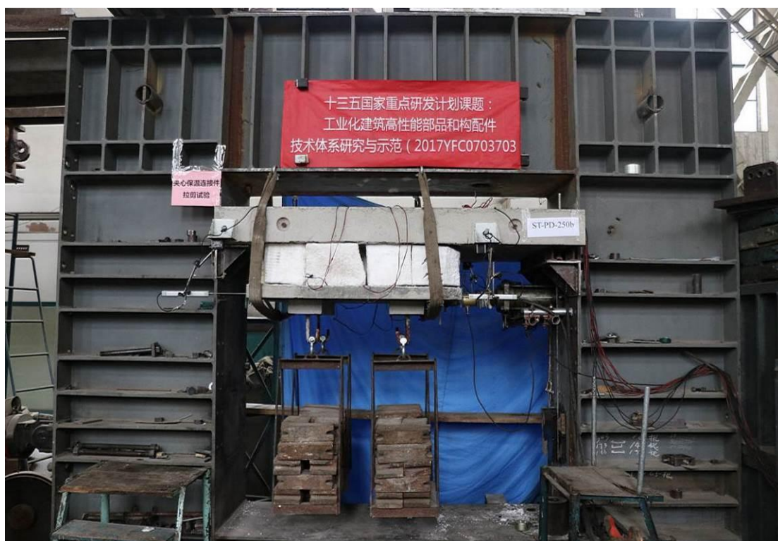
图 11 连接件拉剪试验装置
