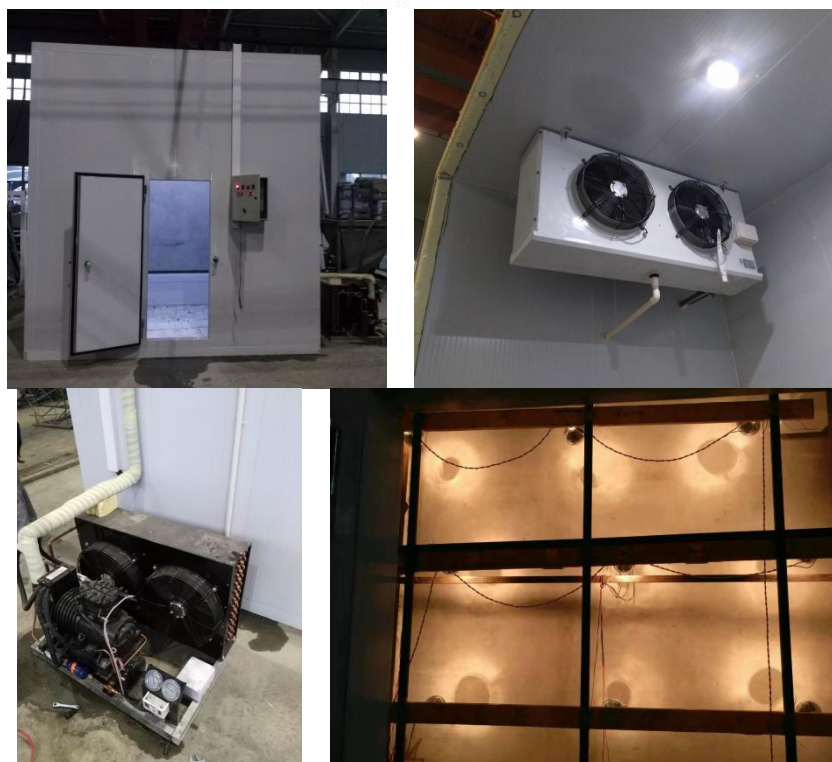
图 21 夹心保温外墙板温度作用试验装置
