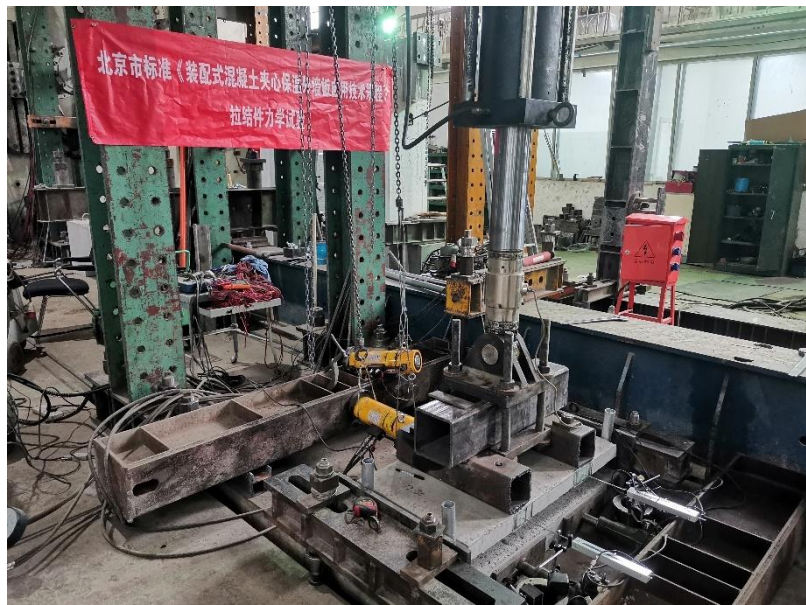
图 42 板式拉结件拉剪试验装置
