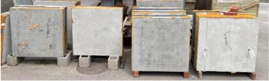
图47 传热系数试验样件
