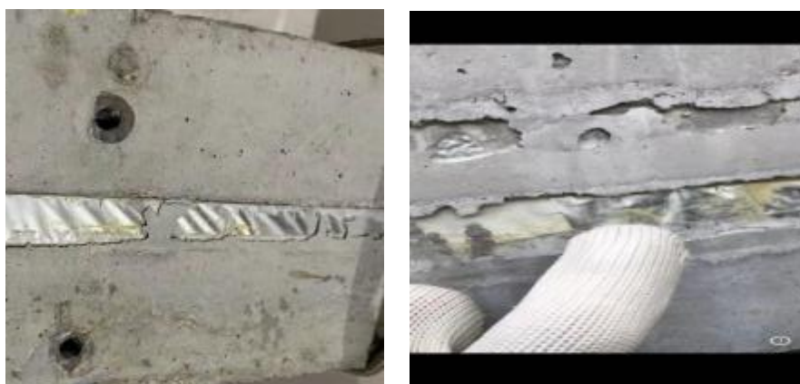
图 51 真空绝热板试件样品漏气起鼓照片
